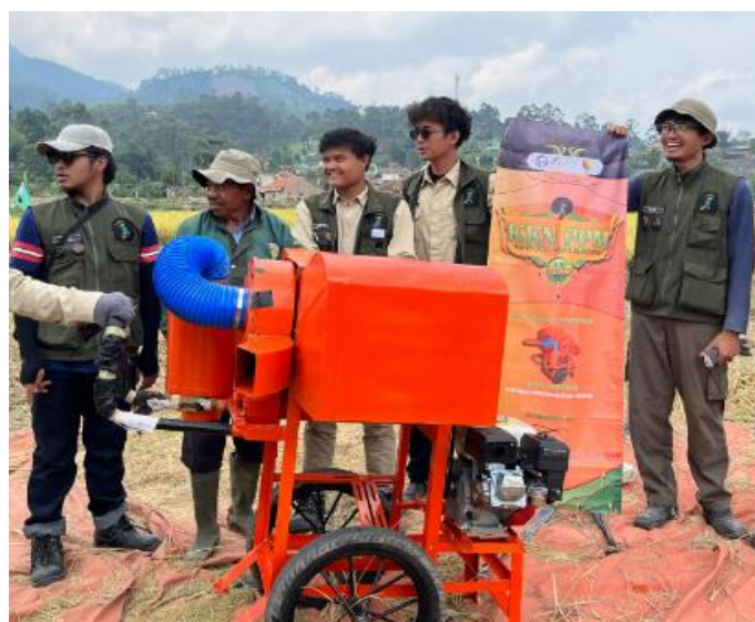
Gambar 2. Mesin Perontok Padi Portabel yang Sedang Digunakan di Lahan Pesawahan Desa
