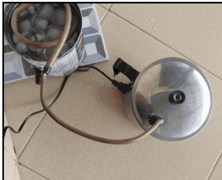
Gambar 4. Proses Destilasi Dengan Alat Sederhana Yang Telah Dimodifikasi
