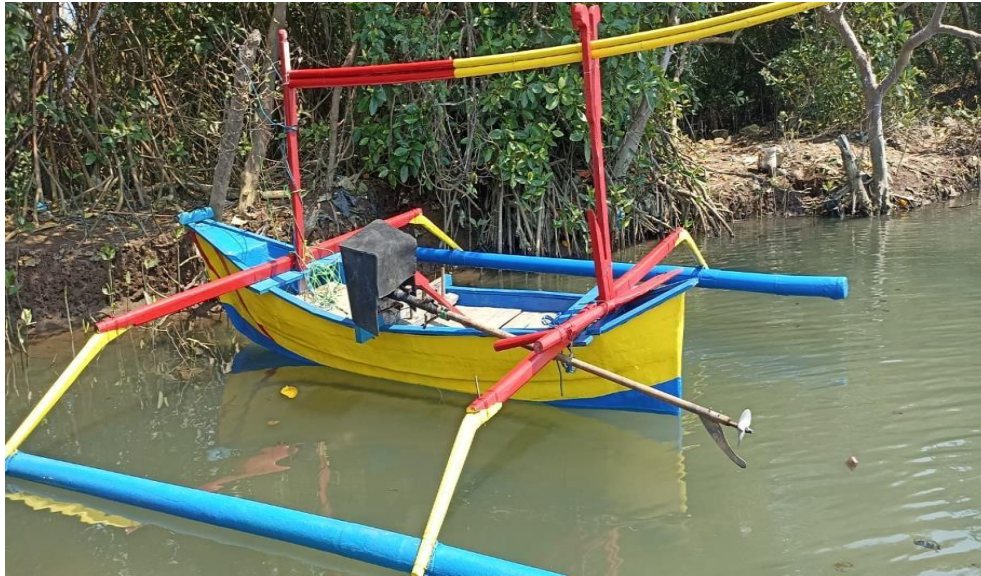
Gambar 3. Perahu yang telah dilaminasi
