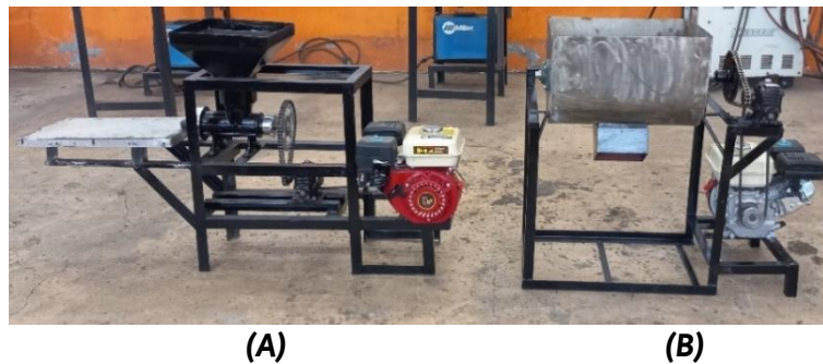
Gambar 6. (A). Mesin Pencetak Briket; (B). Mesin Pengaduk Bahan Briket
