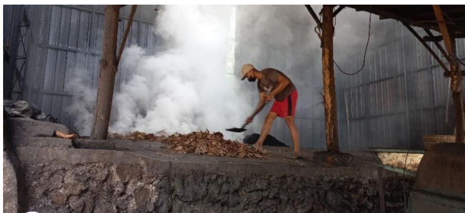
Gambar 4. Proses Pembakaran Tempurung Kelapa untuk Menjadi Arang
