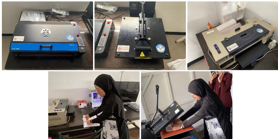
Gambar 7. Peralatan dan Penerapan teknologi DTF
