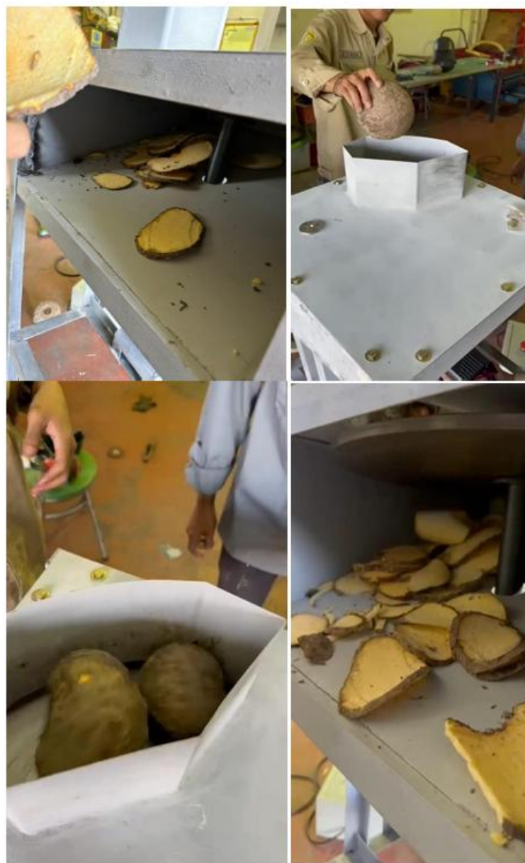
Gambar 4. Uji Coba Mesin Slicer Porang
