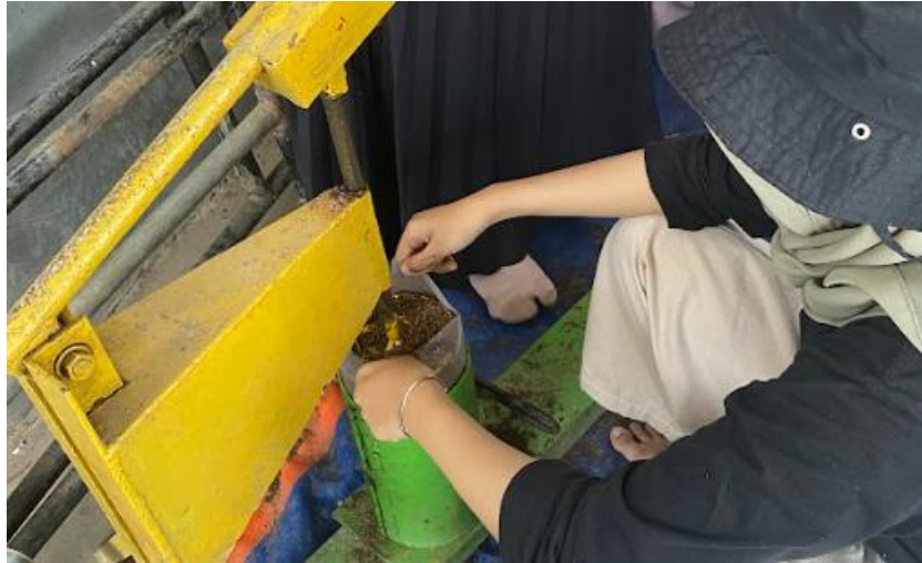
Gambar 3. Memadatkan media dengan mesin press manual
