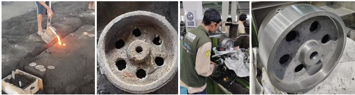
Gambar 6. Proses Pembuatan Puli
