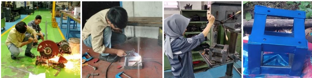
Gambar 7. Proses Pembuatan Dudukan Motor
